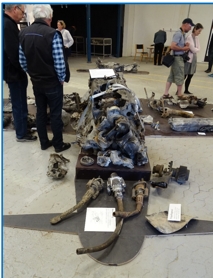
Skabelonen af flyet i naturlig størrelse, hvor de forskellige vragdele efter bedste evne er udlagt, hvor de oprindeligt har været placeret
