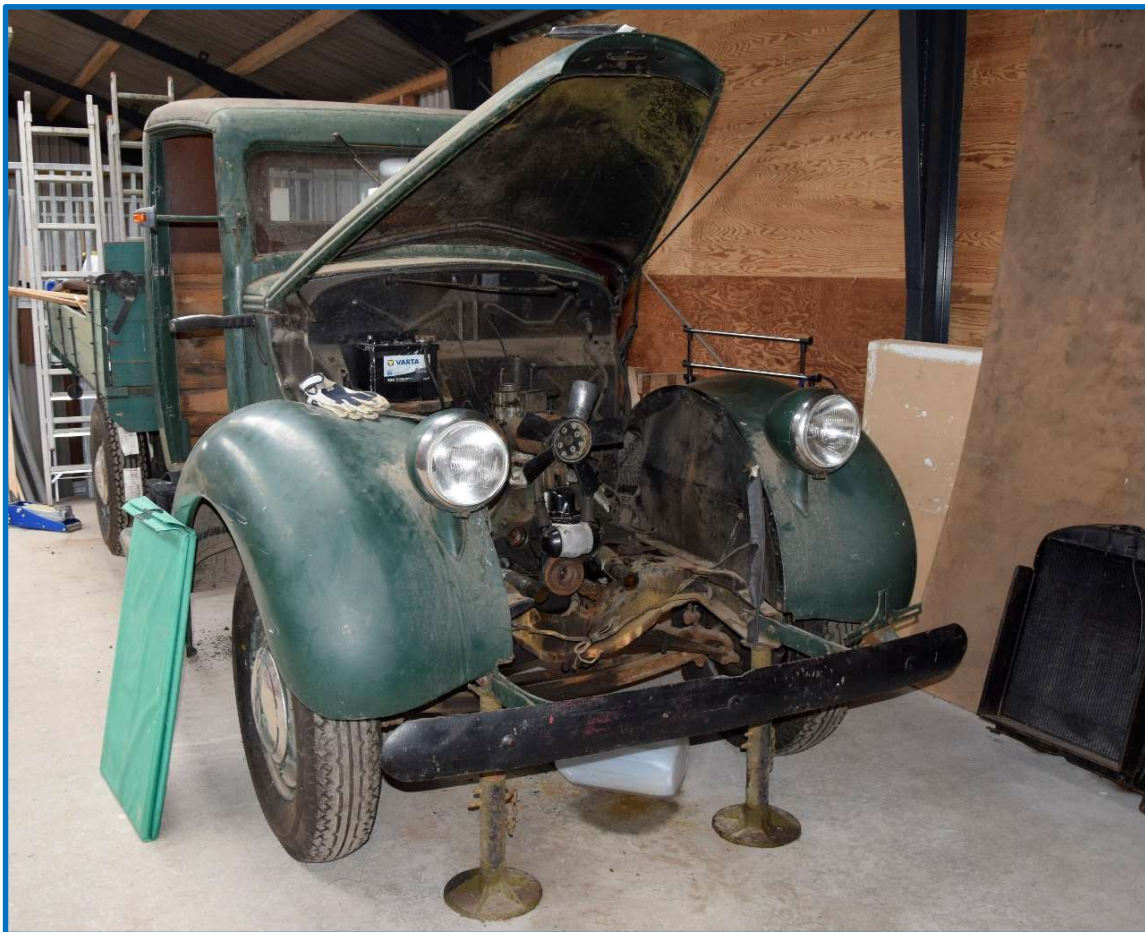
Her er bilen ankommet til værkstedet. Den er blevet klodset op og front, køler og døre er afmonteret
