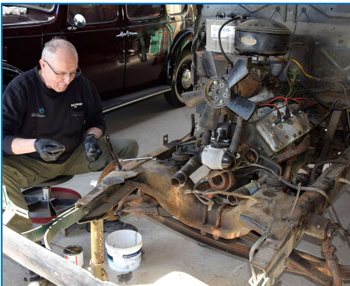
Her er Chefmekaniker Leif Højris godt i gang med rense og smøre bremserne. Bemærk møllen, der sidder på dynamoen, den er af plastik og ikke original. Den er nu skiftet til en original fra en personvogn med 4 blade. Den rigtige til en lastbil med 6 blande, mangler jeg stadig
